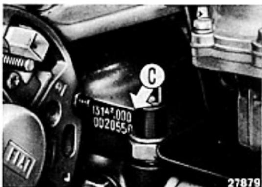
**C. Tipo e numero d'identificazione del motore:** sono stampigliati sul blocco cilindri, in prossimità del distributore d'accensione.
