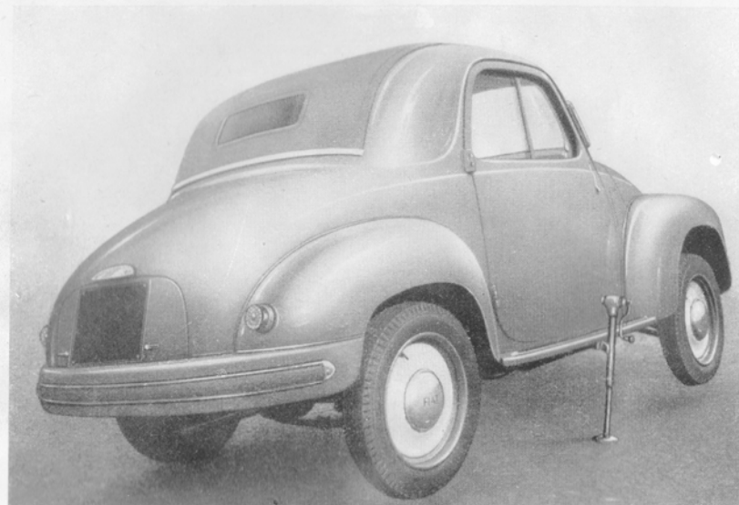
Fig. 60. - Sollevamento vettura mediante martinetto.
