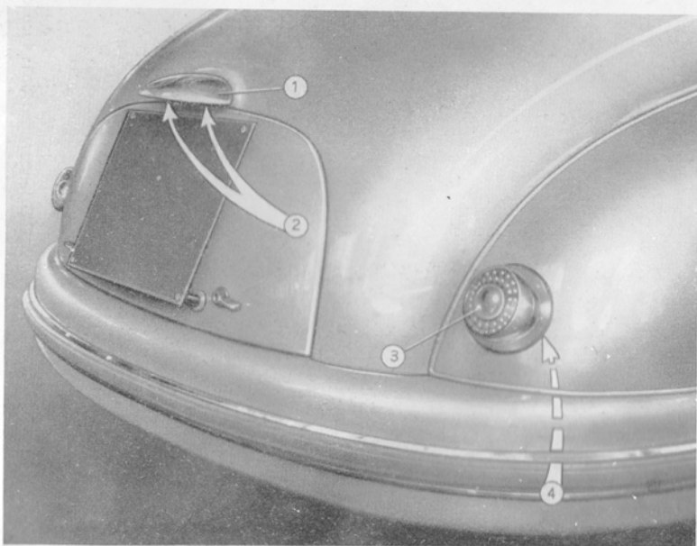
Fig. 50. - Apertura del fanaletto targa e dei fanaletti posteriori d'ingombro e d'arresto. 1. Fanaletto targa. - 2. Le frecce indicano le viti da allentare per accedere alla lampadina. - 3. Fanaletto segnalatore d'ingombro e d'arresto. - 4. La freccia indica la posizione della staffa di fissaggio del fanaletto.
