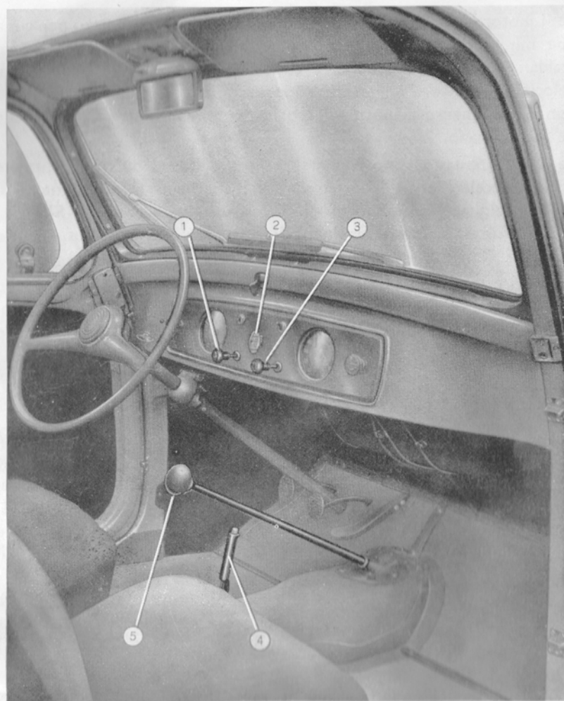
Fig. 17. - Posizione dei comandi all'avviamento a freddo del motore.
