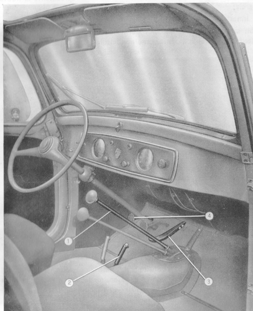
Fig. 18. - Posizione dei comandi all'avviamento della vettura.
