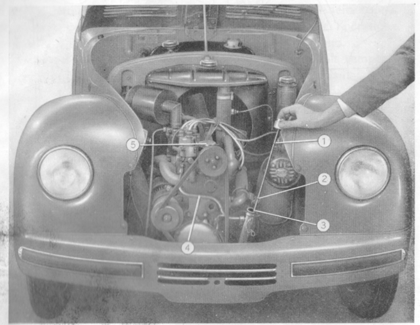
Fig. 23. - Asta indicatrice del livello olio nella coppa. 1. Asta indicatrice del livello. - 2. Livello massimo dell'olio nella coppa. - 3. Livello minimo dell'olio nella coppa. - 4. Tubo per circolazione forzata aria nell'interno del motore. - 5. Bocchettone per introduzione olio nel motore.
