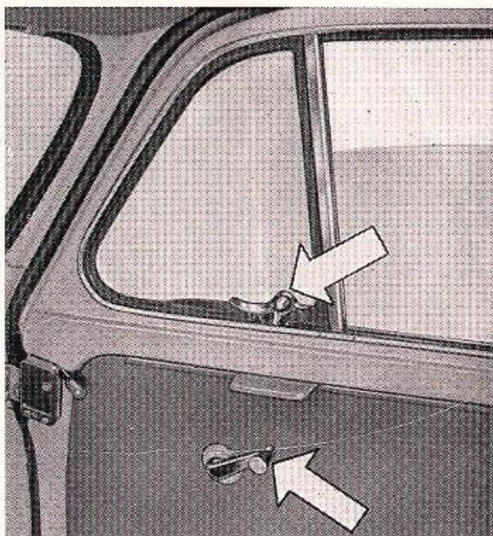
**Riscaldamento invernale.** L'immissione di aria calda nel convogliatore centrale, può essere regolata orientando opportunamente **verso destra** la levetta situata in prossimità del sedile posteriore.
