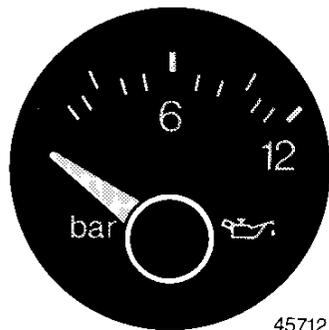
Con motore molto caldo e funzionante al minimo, la lancetta dello strumento può scendere leggermente sotto la linea indicante il valore di 2 bar; il fatto non deve preoccupare se, accelerando anche solo leggermente, la lancetta tende a risalire verso valori superiori.
