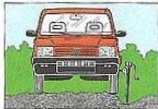
Cuando la elevación máxima del gato, a causa de un terreno malo, no permite levantar desde el suelo la rueda que se debe cambiar, utilice este soporte colocándolo debajo de la base del gato con la parte dentada a contacto con el suelo. Después que lo ha utilizado, coloque el soporte debajo de la rueda de repuesto.
