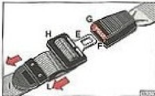
Para regular el cinturón, haga deslizar la cinta que sea necesaria por el regulador H: tire del cable I para estrecharlo, y del tramo L para alargarlo.
