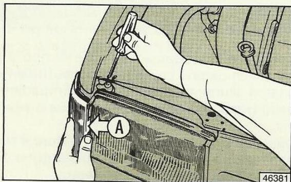
rio premere con il cacciavite la linguetta A di bloccaggio del gruppo trasparente e sfilarlo dalla parte anteriore. La lampada D risulta così facilmente accessibile, in quanto è inserita a pressione nel portalampada.
