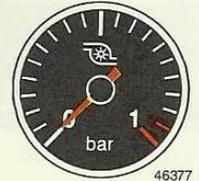
In condizioni normali di funzionamento, la pressione deve essere compresa tra 0 e 0,75 bar per motore a benzina e 0,9 bar per motore diesel. Qualora dovesse superare il valore massimo, rivolgersi alla Rete Assistenza FIAT.
