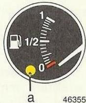
L'accensione della spia «a» indica che nel serbatoio è rimasta una riserva di circa 5 ÷ 7 litri di carburante. La capacità del serbatoio per la versione Turbo benzina è di circa 50 litri mentre per le altre versioni è di circa 42 litri.
