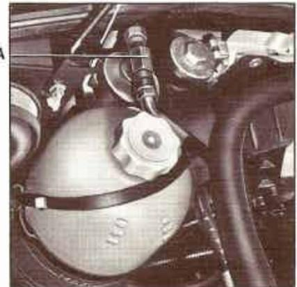
Una mirilla A, situada en lo alto de la botella deshidratante, permite verificar que hay freón. La presencia de burbujas indica una pérdida de líquido. Esta verificación es válida solamente después de que la instalación esté en marcha durante algunos minutos.
