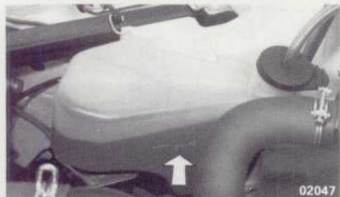
El líquido del sistema de refrigeración sale de fábrica provisto con un compuesto de agua con aditivos anticongelantes y anticorrosivos.
