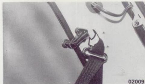
Para abrir el cristal posterior, tirar de la palanca y empujar el cristal.
