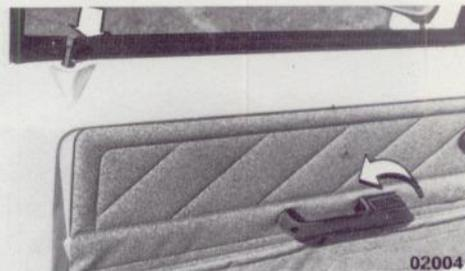
Bloqueo desde el interior; pulsar el botón cuando la puerta esté cerrada. No pulsar el botón cuando la puerta esté abierta porque el dispositivo de bloqueo no entra en funcionamiento y la cerradura puede estropearse.
