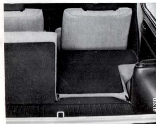
Per l'ampliamento del vano baule nelle vetture munite di sedili posteriori divisi, attenersi a quanto detto in precedenza, tenendo presente che il ribaltamento degli schienali avviene singolarmente. Secondo la disposizione dei sedili posteriori si può ottenere un piano di carico limitato più una persona sul sedile posteriore laterale, oppure di grande capacità.
