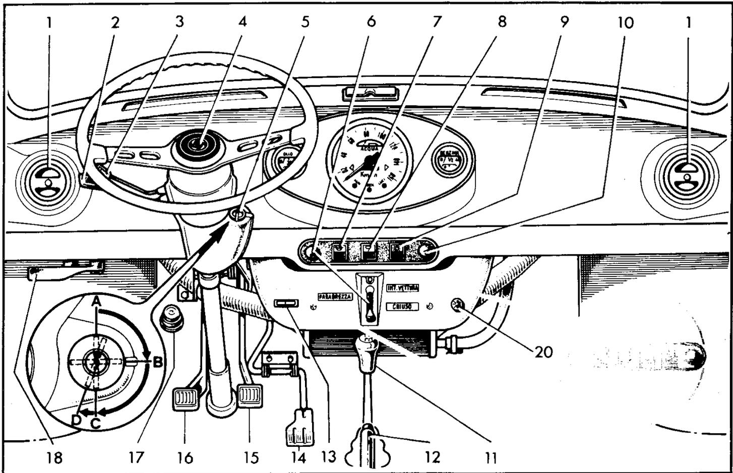
**1 - Bocchette per aerazione interno vettura** - Orientabili e con possibilità di regolazione del flusso di aria (vedere a pag. 11 «Ventilazione e riscaldamento»).
