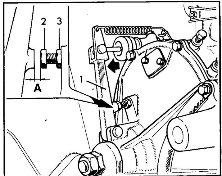
che sul cilindretto operatore della frizione esiste una vite apposita. A tale scopo procedere come segue: - Svitare leggermente detta vite; - azionare il pedale della frizione sino a che tutta l'aria è fuoriuscita dallo spurgo; - serrare la vite.
