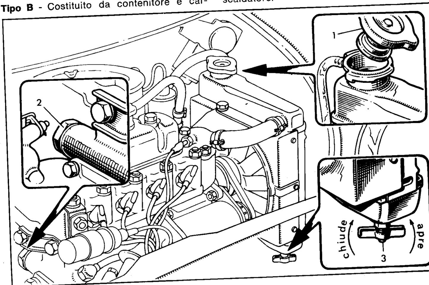
Si avverte che il semplice scarico dell'acqua dal motore e dal radiatore, mentre salvaguarda questi ultimi da rottura per gelo, può non essere sufficiente per quanto riguarda il riscaldatore del condizionatore d'aria, poiché in tale riscaldatore rimane sempre una certa quantità d'acqua.
