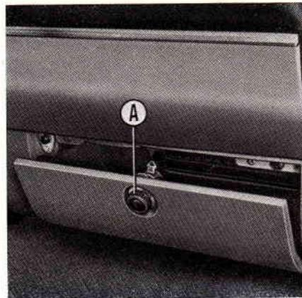
**Cassetto ripostiglio:** si apre ruotando in senso antiorario il pomello **A**; all'apertura si accende automaticamente la lampada per illuminazione dell'interno se la chiave del commutatore d'accensione è nella posizione « MAR ». All'interno sono sistemati i fusibili di protezione dell'impianto elettrico.
