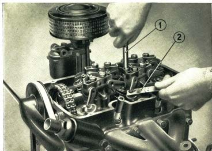
Fig. 10. Registrazione del gioco delle valvole.
