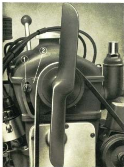
Fig. 26. Regolazione della tensione della cinghia del ventilatore.
