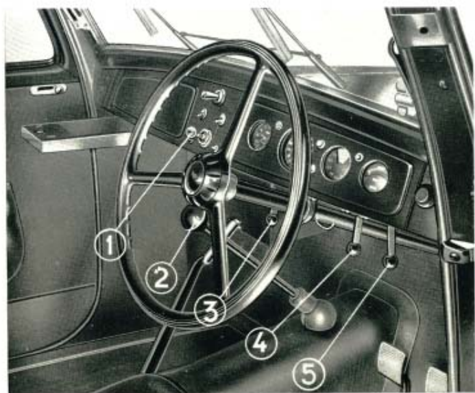
Fig. 5. Comandi per l'avviamento del motore.
