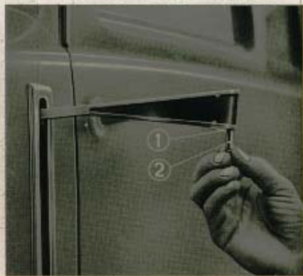
Fig. 45. Sostituzione della lampadina degli indicatori di direzione.
