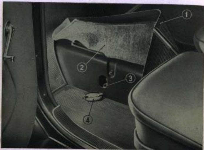
Fig. 32. Lubrificazione del cambio di velocità.
