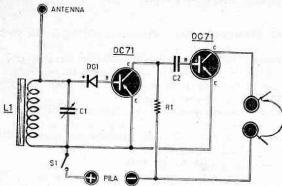
Fig. 61 - Schema elettrico.
