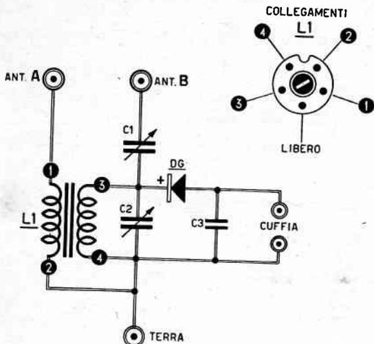
Fig. 23 - Schema elettrico del ricevitore RX9.
