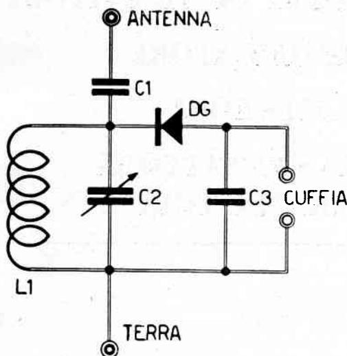
Fig. 1 - Schema elettrico del ricevitore RX1.
