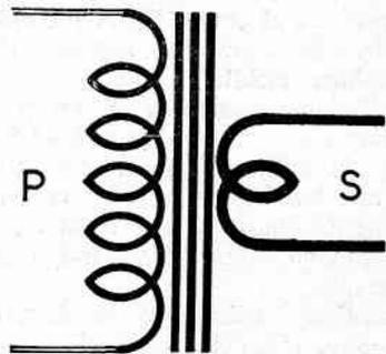
Fig. 89 - Rappresentazione grafica convenzionale di un trasformatore d'uscita.
