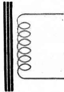
Fig. 45 - Convenzionalmente le bobine con nucleo ferromagnetico si rappresentano parimenti alle bobine di tipo cilindrico con linee indicanti il nucleo fuoriuscente dalle estremità della bobina stessa.
