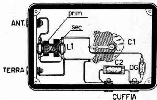
Fig. 16 - Custodia in bachelite per ricevitore a galena.
