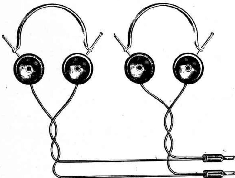
Fig. 84 - Collegamento in parallelo di due cuffie elettromagnetiche.
