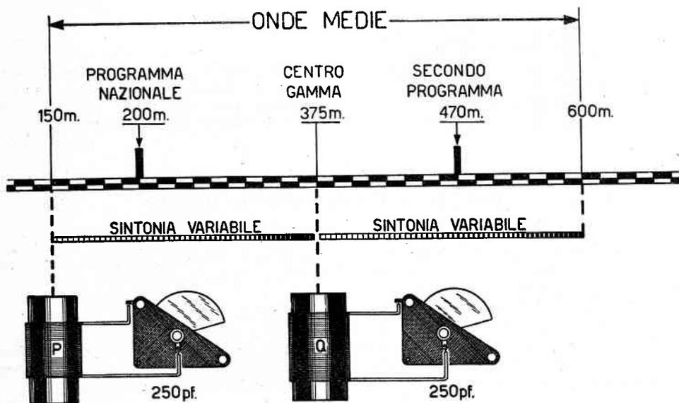
Fig. 69 - Con la messa in opera di condensatori di capacità inferiore alla necessaria saremo in grado di esplorare soltanto una porzione di gamma delle Onde Medie.
