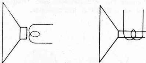
Fig. 86 - Rappresentazioni grafiche convenzionali dell'altoparlante magnetodinamico.
