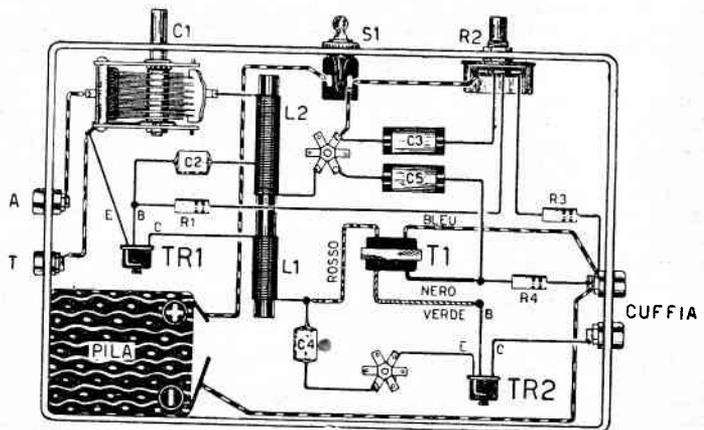
Fissati che risultino al telaio il variabile C1, l'interruttore S1, il potenziometro R2 e le boccole isolate per la presa antenna-terra e uscita segnale, daremo inizio al cablaggio.
