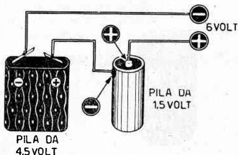
Fig. 102 - E' possibile pure il collegamento in serie di pile a diverso voltaggio.
