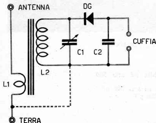
Fig. 42 - Schema elettrico dell' RX17.
