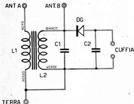
Fig. 25 - Schema elettrico dell'RX9 bis.
