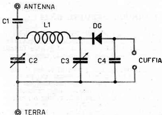
Fig. 38 - Schema elettrico dell'RX15.
