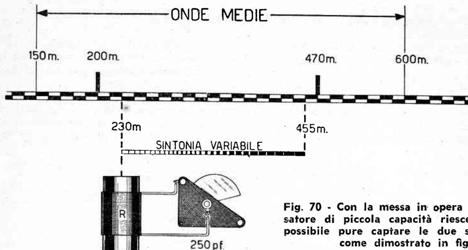
Fig. 70 - Con la messa in opera di un condensatore di piccola capacità riesce a volte impossibile pure captare le due stazioni locali, come dimostrato in figura.
