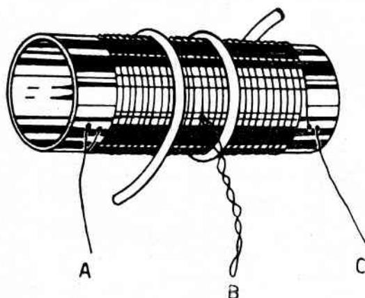
**Fig. 54 - Esempificazione costruttiva delle bobine L1-L2.**
