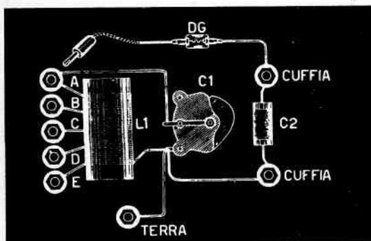
Fig. 9 - Schema pratico del ricevitore RX3.
