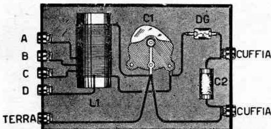
Fig. 7 - Schema pratico del ricevitore RX2.
