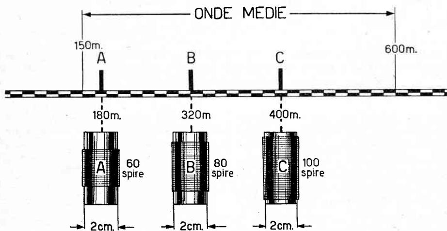
**Fig. 58 - Ogni bobina con determinato numero di spire presenta la caratteristica di risultare sintonizzata su una specifica lunghezza d'onda. Maggiore è il numero di spire a parità di diametro, maggiore è la lunghezza d'onda in metri sintonizzata.**
