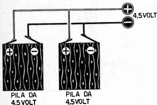
**Fig. 105** - Collegando in parallelo due pile a egual voltaggio, la corrente risultante sarà pari alla somma delle correnti singole, mentre la tensione risulta eguale alla tensione singola di ogni pila.
