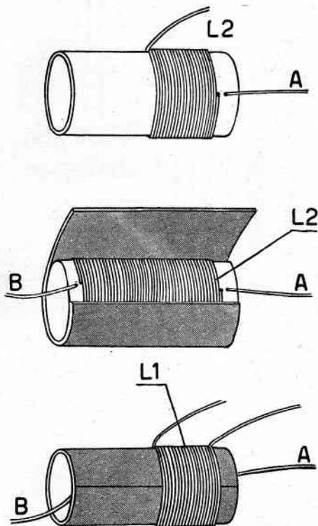
Fig. 32 - Esempificazione fasi costruttive L1 ed L2.
