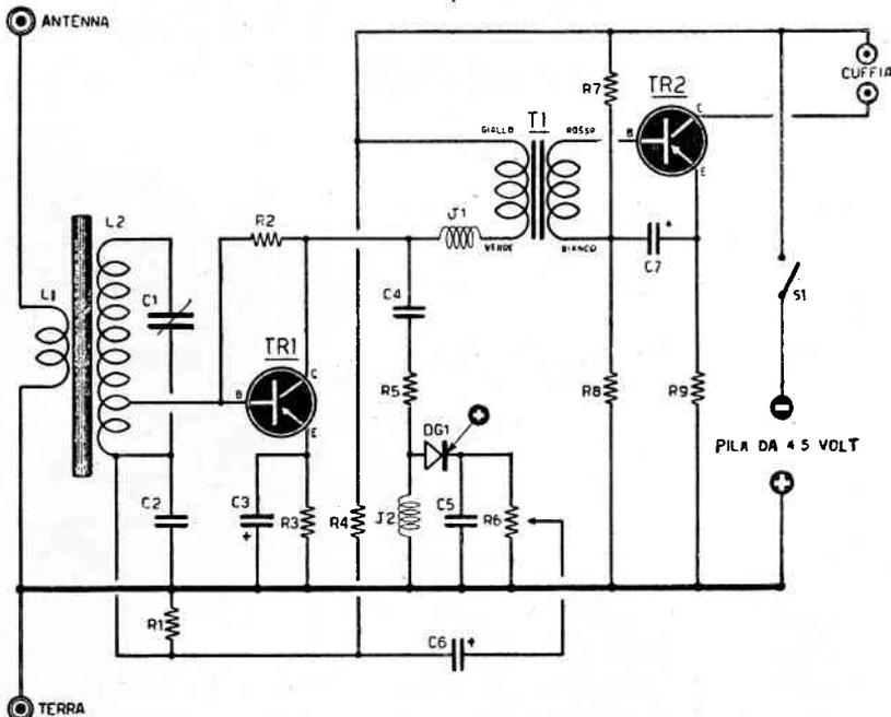
**Fig. 72 - Schema elettrico del Reflex a 2 transistori**
