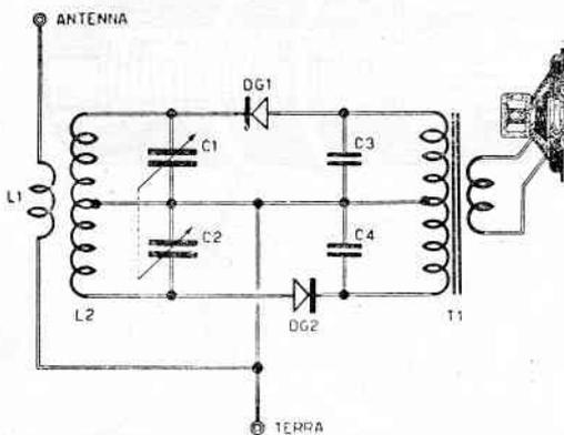
Fig. 57 - Schema elettrico dell'RX23.
