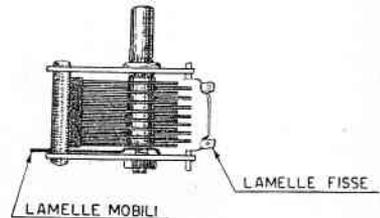
Fig. 24 - In un condensatore a capacità variabile isolato a mica le lamelle mobili risultano centri corpo unico col perno di comando.
