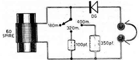
Fig. 63 - Sempre per la sintonizzazione su tre lunghezze d'onda diverse, si potranno inserire in parallelo alla bobina, a mezzo di un deviatore, condensatori a capacità fissa.
