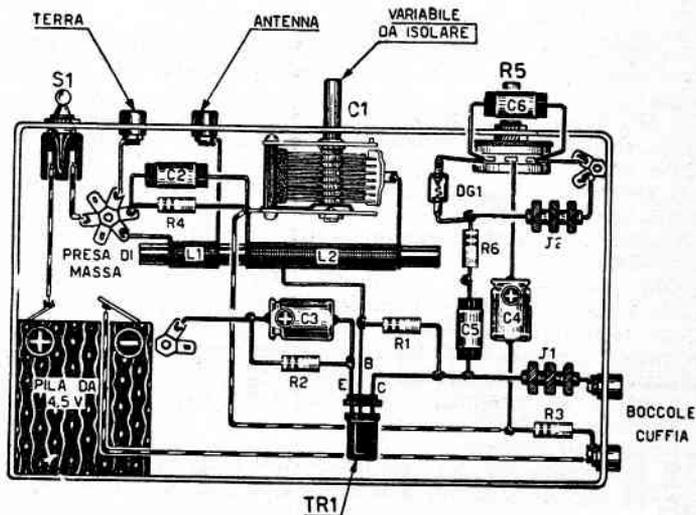
Fig. 71 - Schema elettrico del Reflex a 2 transistori
