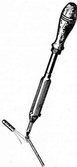
di iniziare la saldatura, eliminare lo strato di ossido che ricopre la superficie del metallo da trattare, facendo uso di deossidanti che puliscano le superfici. Molti dilettanti usano, come deossidanti, acidi corrosivi che, anche se danno buoni risultati, hanno il grave difetto di corrodere, con i loro fumi e i loro spruzzi, le altre
