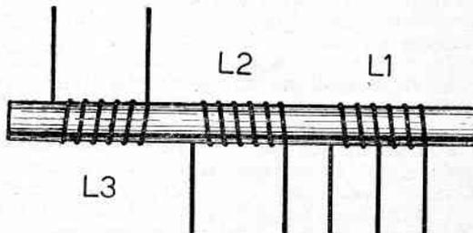
Fig. 68 - Bobine L1-L2 avvolte su nucleo ferroxcube.
