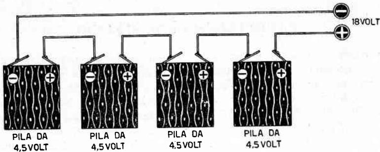
**Fig. 104** - La tensione risultante dal collegamento in serie di più pile a tensione eguale sarà data dalla somma delle tensioni singole.
