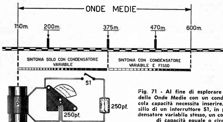
Fig. 71 - Al fine di esplorare l'intera gamma delle Onde Medie con un condensatore di piccola capacità necessita inserire, mediante l'ausilio di un interruttore S1, in parallelo al condensatore variabile stesso, un condensatore fisso, di capacità eguale o circa eguale.
