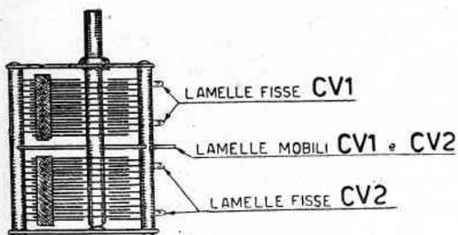
Fig. 26 - In un condensatore a capacità variabile a due sezioni le lamelle mobili risultano facenti corpo unico col perno di comando.
