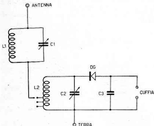
Fig. 29 - Schema elettrico dell'RX11.
