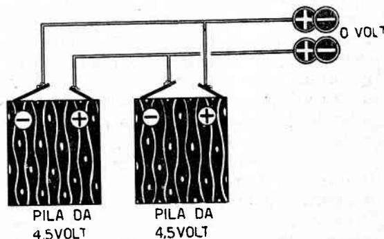
**Fig. 106** - Per raggiungere il collegamento in parallelo di due pile, necessiterà collegare i terminali della stessa polarità. Nel caso il collegamento abbia effetto come indicato a figura, le pile si scaricheranno senza dar luogo a erogazione di corrente.
