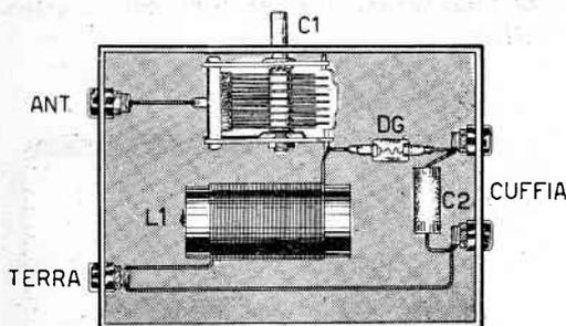
Fig. 13 - Schema pratico del ricevitore RX5.
