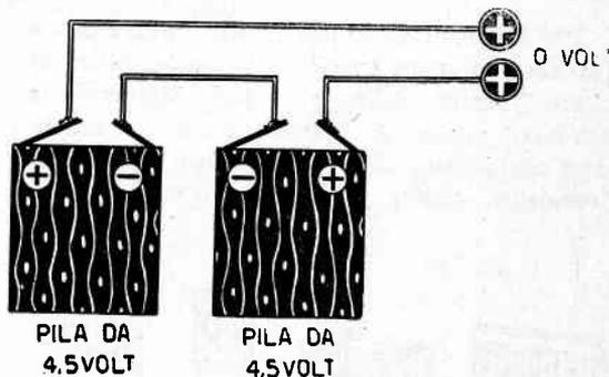
Fig. 103 - Per raggiungere il collegamento in serie di due pile, necessiterà collegare il polo positivo dell'una col polo negativo dell'altra. Nel caso il collegamento abbia effetto come indicato a figura, non si avrà, ai terminali del collegamento, erogazione di corrente.
