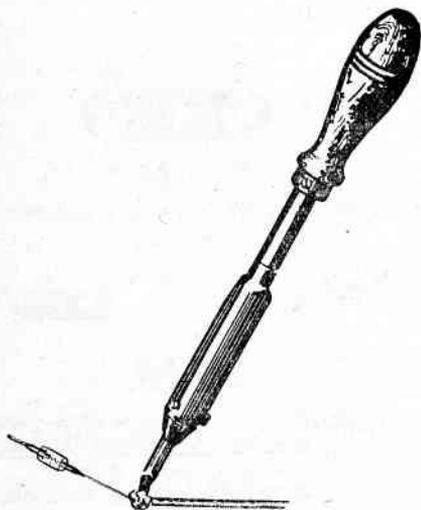
Fig. 127 - Buona norma prudenziale sarà quella di operare le saldature all'estremità dei terminali dei diodi e dei transistori.
