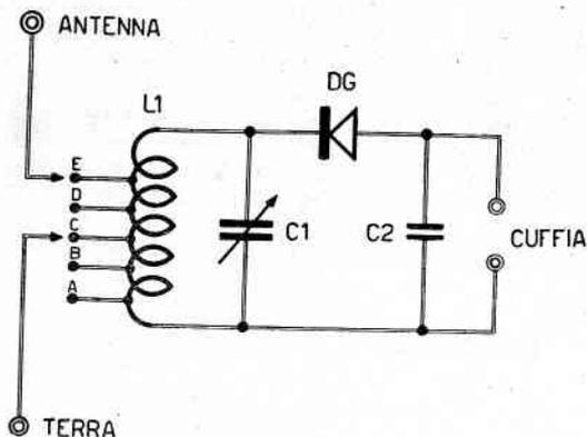
Fig. 19 - Schema elettrico del ricevitore RX7.
