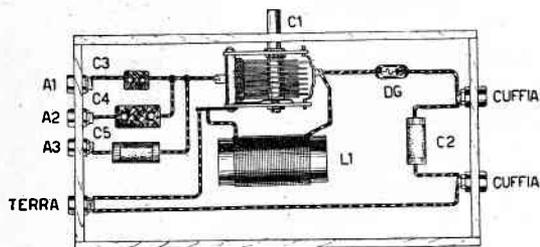
Fig. 22 - Schema pratico del ricevitore RX8.
