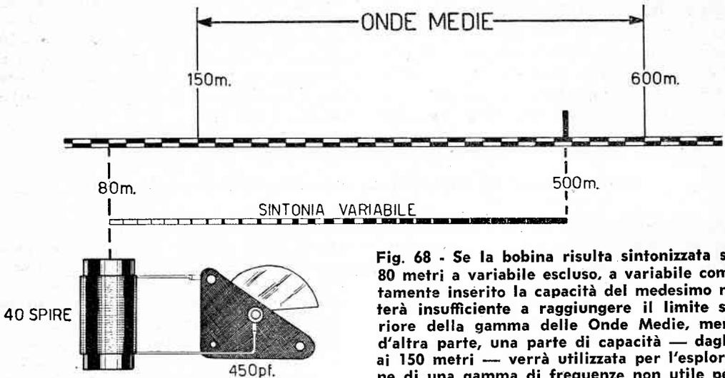
Fig. 68 - Se la bobina risulta sintonizzata sugli 80 metri a variabile escluso, a variabile completamente inserito la capacità del medesimo risulterà insufficiente a raggiungere il limite superiore della gamma delle Onde Medie, mentre, d'altra parte, una parte di capacità — dagli 80 ai 150 metri — verrà utilizzata per l'esplorazione di una gamma di frequenze non utile per le radio diffusi.
