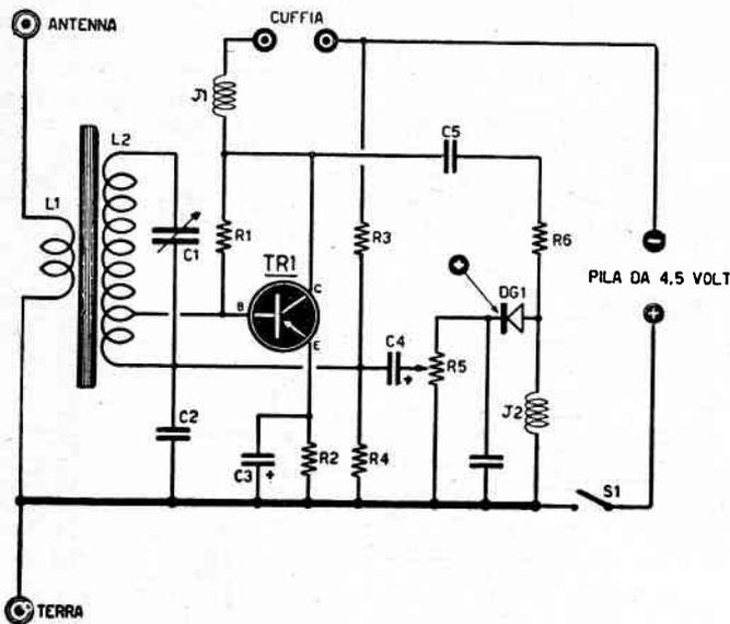
Fig. 70 - Schema elettrico del Reflex a 1 transistor
