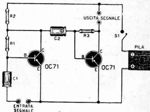
10.000 ohm. La pila da utilizzare sarà del tipo a 3 volt. In figura 85 appare lo schema pratico dell'amplificatore a due transistori.
