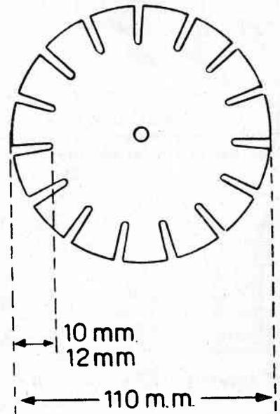
Fig. 36 - Dimensioni del supporto in cartoncino per una bobina a fondo di paniero.
