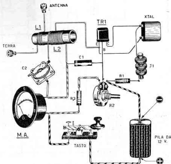
metro mm. 0,2, con presa alla 31<sup>a</sup> spira. Diametro supporto mm. 25. L1 viene sistemata a lato di L2 (distanza 5 mm.), oppure — nel caso si desideri conseguire maggiore efficacia — avvolta su L2. L1 consta di numero 5 spire in filo di rame smaltato diametro mm. 0,60.
