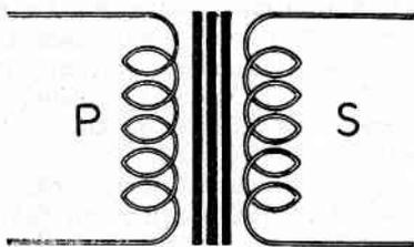
Fig. 92 - Rappresentazione grafica convenzionale di un trasformatore.
