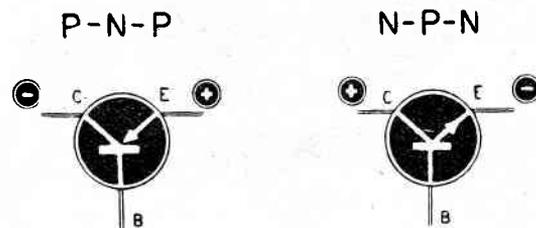
Fig. 80 - Per la distinzione grafica dei transistori tipo PNP da quelli di tipo NPN usati rivolgere la freccia dell'Emittore internamente per il PNP ed esternamente per NPN.
