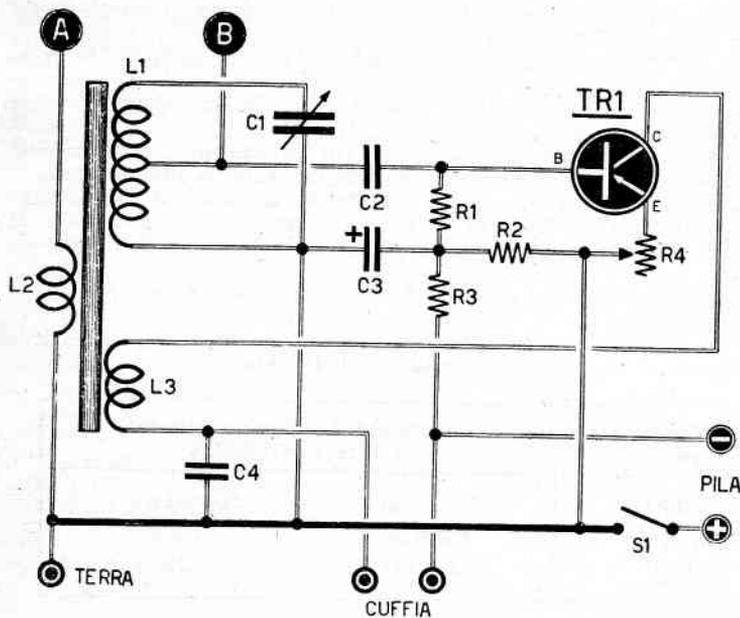
Fig. 67 - Schema elettrico.
