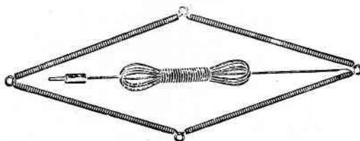
Fig. 120 - Antenna interna a spirale a quattro angoli.
