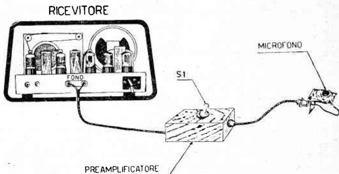
Per il collegamento dell'uscita del preamplificatore alla presa FONO dell'apparecchio ricevente, nel caso che questo ultimo si trovasse molto distante dal preamplificatore stesso, faremo pure uso di cavetto schermato, tenendo sempre presente che la calza metallica dello stesso dovrà risultare collegata al filo di MASSA.
