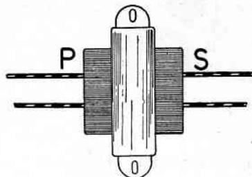
Fig. 93 - Altro sistema di rappresentazione di un trasformatore.
