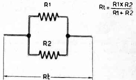
Fig. 10 - Il valore in ohm di due resistenze collegate in parallelo risulta inferiore al valore della resistenza di minor valore singolo.
