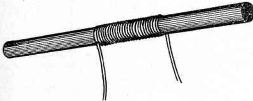
Fig. 43 - Bobina cilindrica avvolta su nucleo ferromagnetico.
