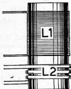
Fig. 51 - Una bobina di tipo cilindrico può risultare, a volte, comprensiva di due avvolgimenti affiancati sullo stesso supporto.
