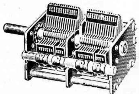
Fig. 25 - Condensatore a capacità variabile isolato in aria a due sezioni.
