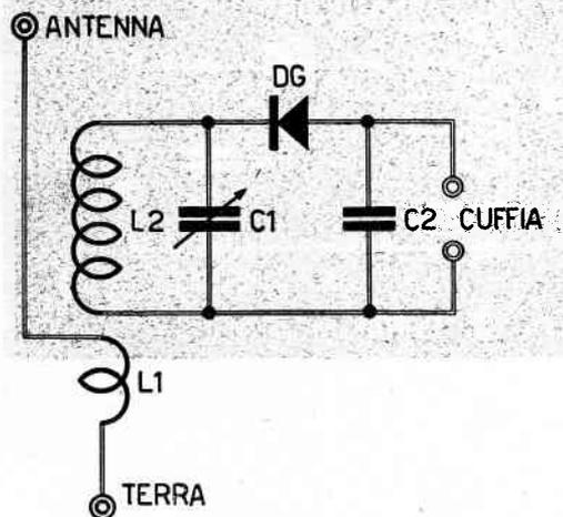
Fig. 10 - Schema elettrico del ricevitore RX4.
