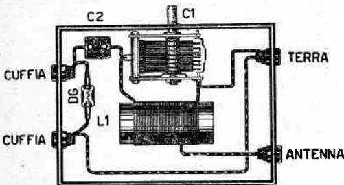
Fig. 18 - Schema pratico del ricevitore RX6.
