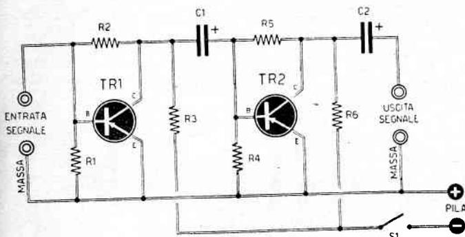
Fig. 78 - Schema elettrico.
