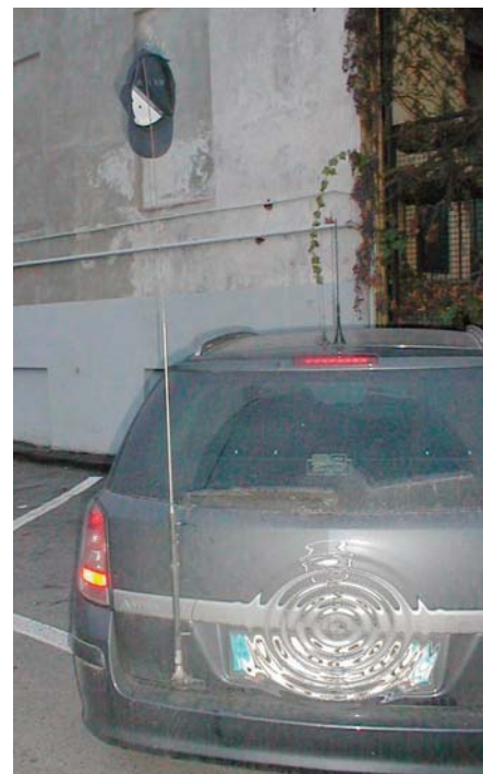
Antenna HF in auto, il cappellino evidenzia la lunghezza dello stilo
