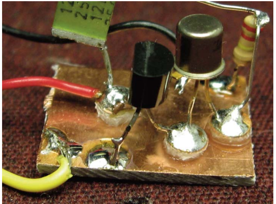
Oscillatore montato con tecnica manhattan by IK1BLK
