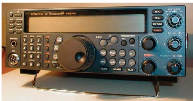
Kenwood TS570, è un RTX HF con accordatore interno e DSP. Della metà degli anni '90, oggi potrebbe valere 500 – 600 euro.
