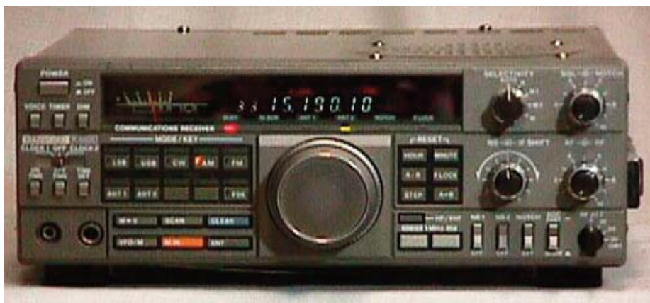
Kenwood R5000, ricevitore di classe, interamente analogico, come molti esemplari della fine degli anni '80 era la versione senza trasmettitore di un ricetrasmittente, nello specifico del Kenwood TS440.
