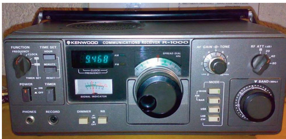
Il fratello maggiore, più o meno contemporaneo, Kenwood R1000, vale qualcosa in più, ne condivide il sistema di sintonia, è probabilmente l'ultimo a non utilizzare il PLL
