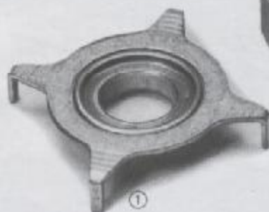
10) Rotori del distributore d'accensione per trasduttore induttivo ① e trasduttore Hall ②
